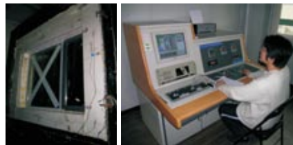
建筑幕墙门窗保温性能检测（3600*4200）
