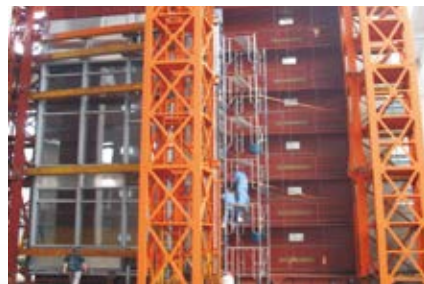
大型建筑幕墙四性检测（10米×16米）
