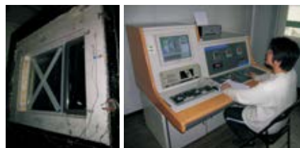
建筑幕墙门窗保温性能检测（3600*4200）
