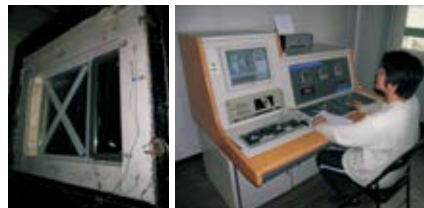
建筑幕墙门窗保温性能检测（3600*4200）
